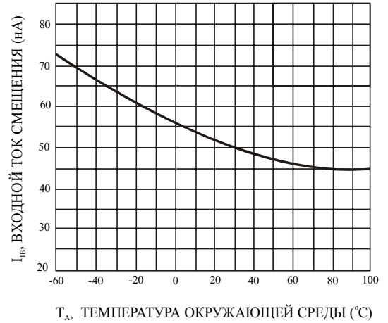
Рисунок 6. Значение входного тока смещения в зависимости от температуры окружающей среды
