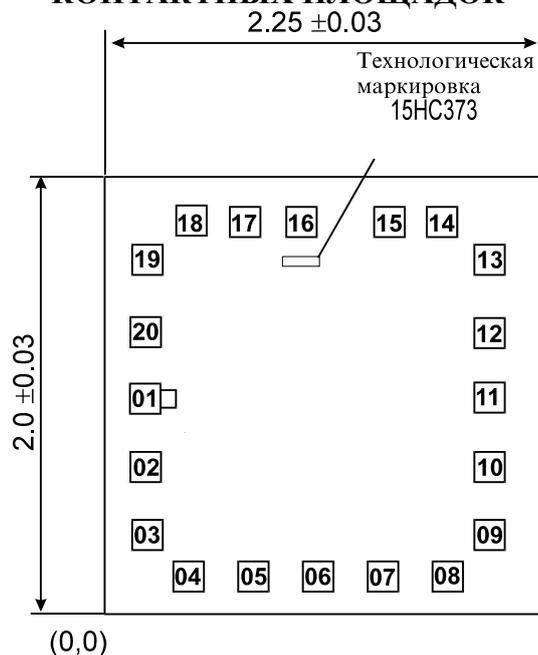
**Координаты технологической маркировки (мм):** левый нижний угол  $x=1.055$ ,  $y=1.646$ ;
