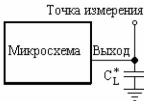
\* Суммарная емкость нагрузки, включая паразитные емкости
