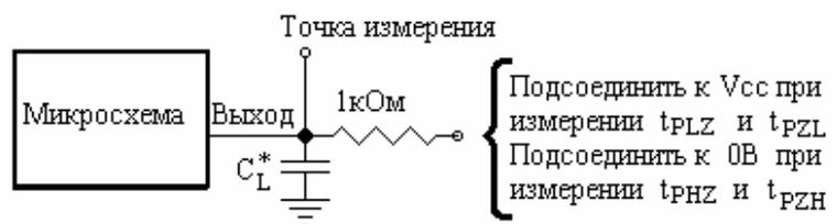
\* Суммарная емкость нагрузки, включая паразитные емкости
