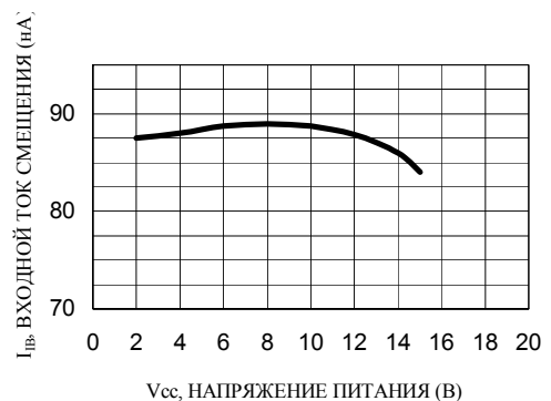
Рисунок 6. Значения входного тока смещения в зависимости от напряжения сигнала
